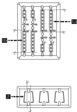
Für den Personenwagen liegen einige Zurüstteile bei. Die Anordnung ist den Skizzen zu entnehmen. Die Zurüstteile sind in die vorhandenen Bohrungen zu stecken und sollten mit einem Tropfen Sekundenkleber fixiert werden.
