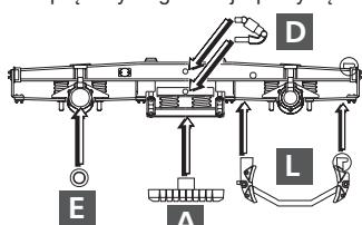
(DE) Drehgestell mit Achsgenerator und Dämpfer für Geschwindigkeiten > 140 km/h
