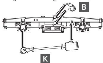
(DE) Drehgestell ohne Lichtmaschine mit Achslagerdeckel
